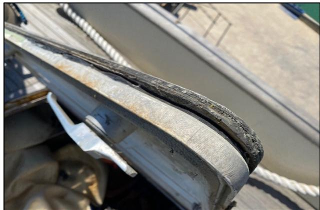
La sigillatura delle zone accoppiate della sovrastruttura risulta distaccata in più punti evidenziando problemi in termini di impermeabilizzazione.
