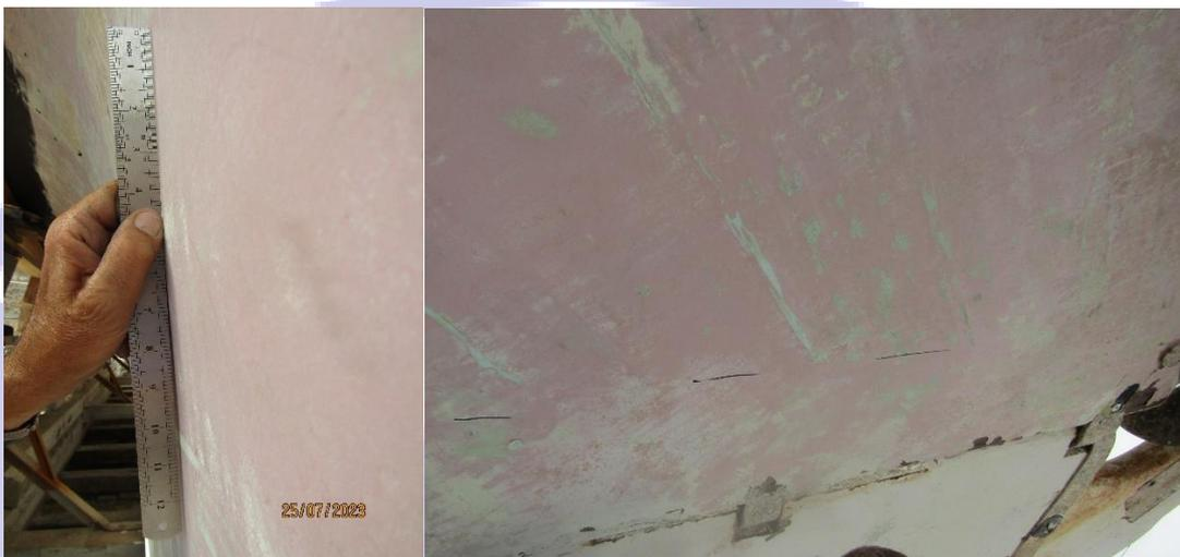
4. L'area del legno in prossimità dell'elemento longitudinale che ospita la losca del timone, quando testata attraverso apposito punteruolo, ha rilasciato copiosa acqua ed è stato testato morbido. In questa area non è stata rimossa la camicia di stucco e il legname non è stato esposto.
